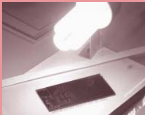
Placa fotosensible y circuito impreso en transparencia bajo la luz
