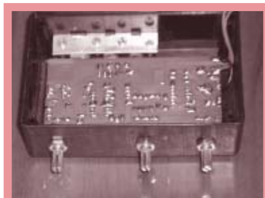
Vistas del circuito terminado inserto en la caja
